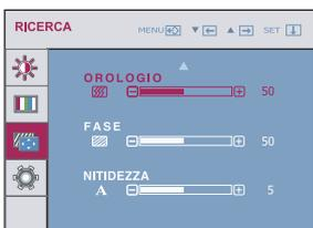
**OROLOGIO** Riduce al minimo le linee o le strisce verticali visibili sullo sfondo dello schermo. Varia anche la dimensione orizzontale dello schermo.
